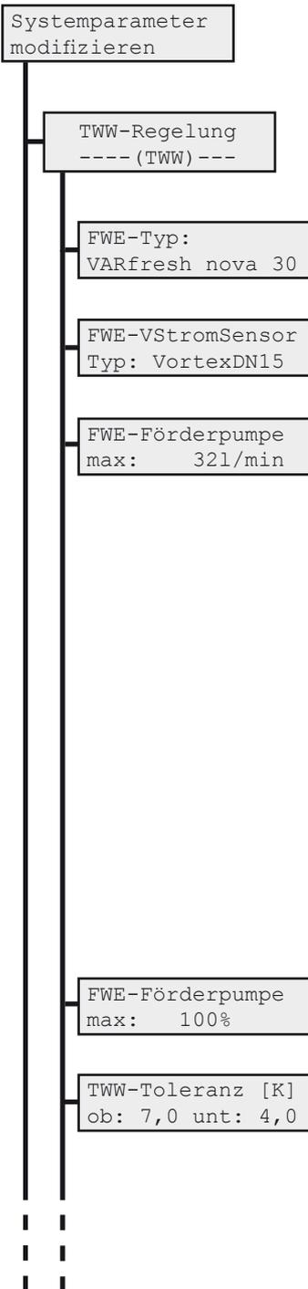
In diesem Menüpunkt können Systemparameter eingesehen und geändert werden. Diese Parameter werden bei Inbetriebnahme automatisch auf Werkswerte gesetzt und können für Optimierungszwecke angepasst werden.
