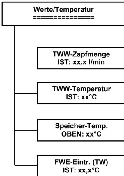
Dieses Menü informiert über die Temperaturmesswerte der angeschlossenen Temperaturfühler und den Messwert des Volumenstromsensors.
