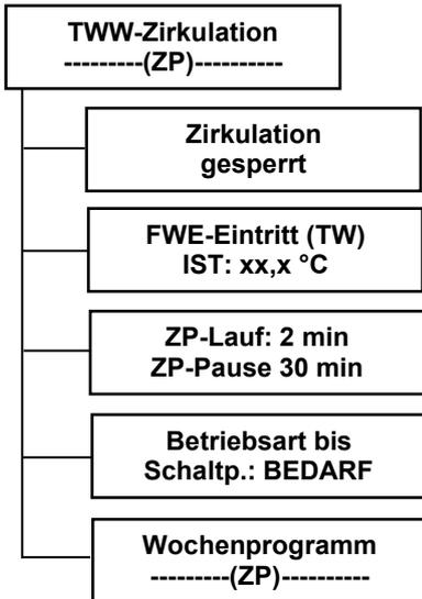
Ist der Zirkulationspumpenbetrieb freigegeben, arbeitet das Gerät voll automatisch. Zu Test- und Prüfzwecken lässt sich die Zirkulationspumpe aber auch sperren oder auf Dauerbetrieb stellen.
