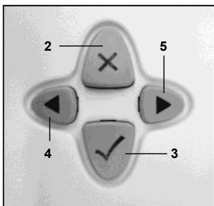
Die X-Taste (2) entspricht funktional der ESC-Taste eines PCs.
