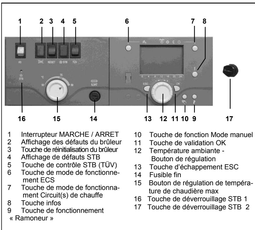
de chauffage. Pour que celui-ci puisse fonctionner sans entrave, il convient de placer le bouton de régulation de la température maxi de la chaudière (15) sur 90°.
