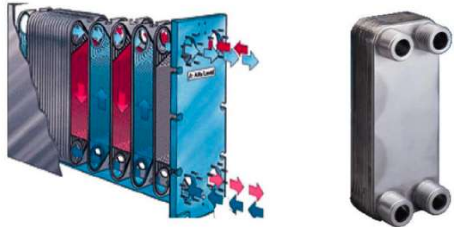
Abbildung 2-13: Schematischer Aufbau eines Plattenwärmetauschers (Rieberer, 2015b)
