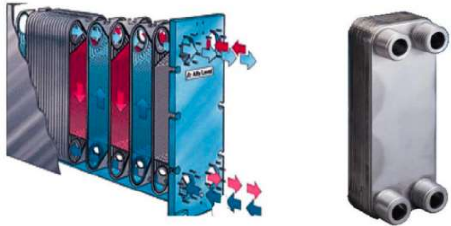
Abbildung 2-13: Schematischer Aufbau eines Plattenwärmetauschers (Rieberer, 2015b)
